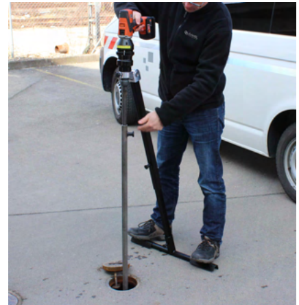
Sonderabstützung Schienenprofil mit Schleppeizer und Winkelscheibe, zur Drehmoment und Drehwinkel Überwachung. Special support rail profile with pointer and angle indicator disk, For torque and rotation angle monitoring.
